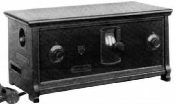
Abb. 1. Fünf Röhren für Gleichstrom in einem stabilen Gehäuse
