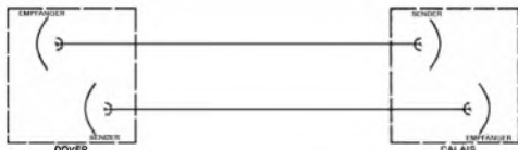
Da Wellen gleicher Wellenlänge verwendet werden, ist jeweils der Empfänger seitlich hinter dem Sender angeordnet, um zu vermeiden, daß der Sender auf den Empfänger unmittelbar strahlt.
