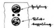
Links: Abb. 2. Antennenan-kopplung für Ortsempfang. Oben: Abb. 4. Frontplatte bei Anwendung eines Heizwiderstandes an Stelle des Schalters.
