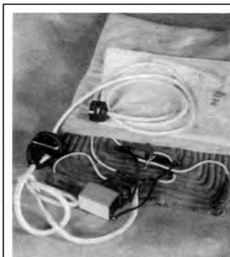
Ein arger Störer, ein Heizkissen mit Temperatur- und Spannungsregler, wurde entstört. (Preis des Kondensators RM. 2.—).
