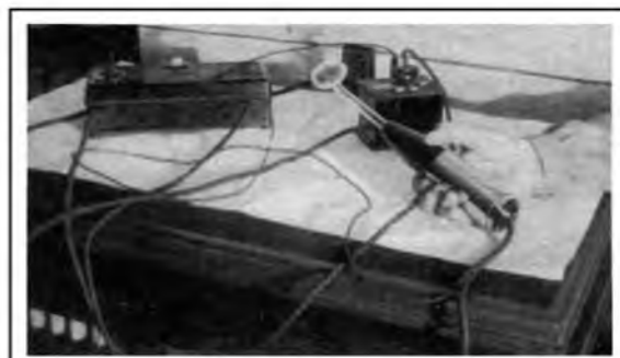
Die Metall-Manschette um den Griff ist einer der wichtigsten Teile des Störschutzes für Hochfrequenzgeräte.
