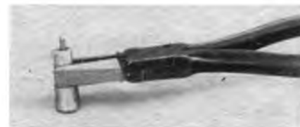
Abb. 2. In einer Minute ist die Sicherung erkaltet und so wieder gebrauchsfähig.
