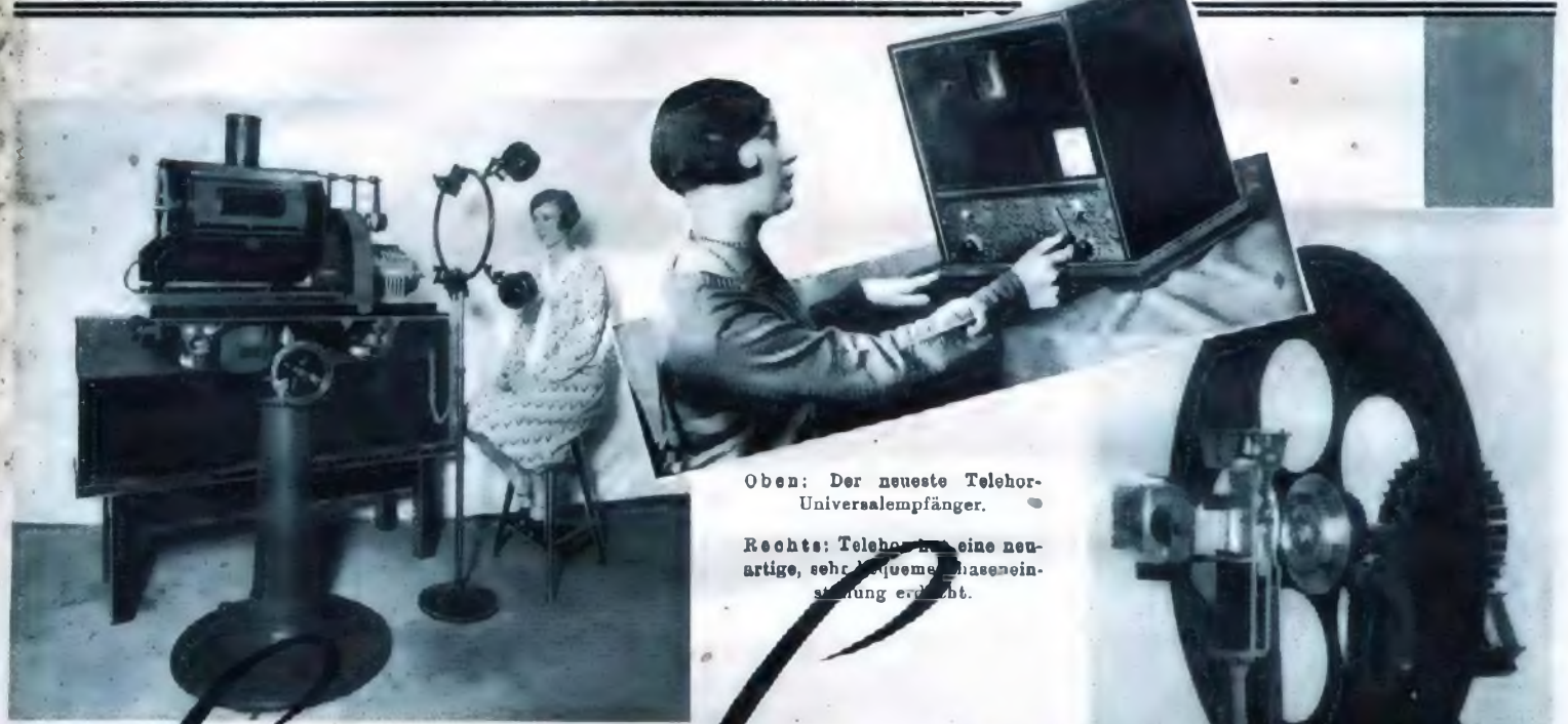
Lichtstrahlender der Fernseh-A.-G., gebaut für die Reichspost. Man sieht deutlich die vier Photokellen.
