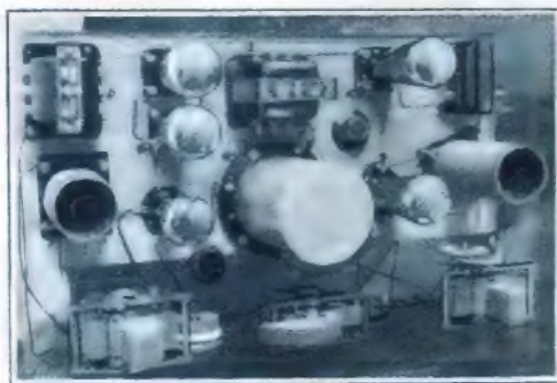
Noch ein „Billiger Vierer“, aber diesmal mit Gegentakstendstufe.
