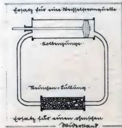
Abb. 5. An Stelle der Wechselstromquelle tritt eine Kolbenpumpe.
