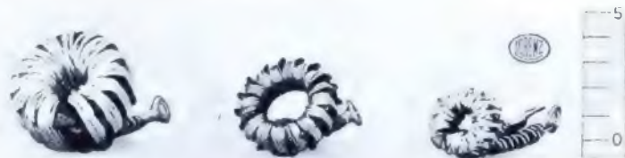
Abb. 4. Wie die eisengefüllten Spulen aussehen, die zur Frequenzvervielfachung benützt werden.
