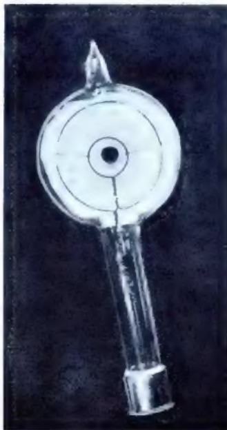
Ältere ringförmige Photozelle nach Dr. Seurüter
