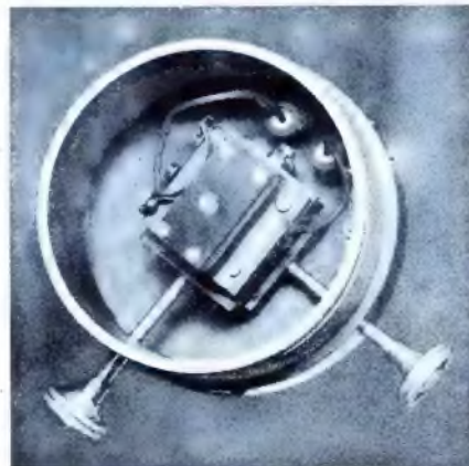
Auch Selenzellen (trotzlich bestehend vervollkommenet, wie z. B. die abgebildete) werden heute noch zu lichtelektrischen Übertragungsversuchen verwendet. Phot. Willinger
