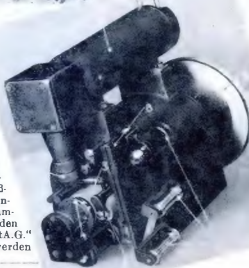
Abb. 4. „Tobis“-Tonprojektor“ (Einheitssystem des deutschen „Tonbild-Syndikats A. G.“). Es bedeuten die Zahlen: 1. Gleitbahn für den Film; 2. Gleitrolle; 3. Tonbahn; 4. Tonbildfenster; 5. Führungsrollen; 6. Tubus mit Belichtungs-lampe für die Belichtung des Tonstreifens, im Knick desselben ein Prisma mit Spaltblende; 7. Linsensystem zum Abbilden des Lichtspaltes auf dem Tonstreifen des Films; 8. Riemenscheibe zum Antrieb des Tonprojektors. Phot. R. Lissner, Berlin.
