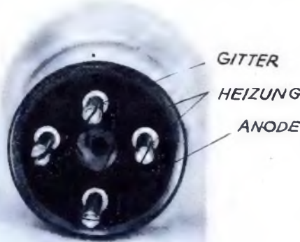
Abb. 6. Wie die Sockelstifte liegen und mit welchen Elektroden sie verbunden sind
