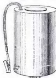
Eine amerikanische Schutznetzröhre, eingebaut in eine Kapsel, aus der nur unten die Steckernetzstifte herausragen.
