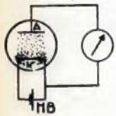
Abb. 2. Den Elektronen wird der Boden zu heiß, sie wandern in Scharen aus dem Heizfaden aus.
