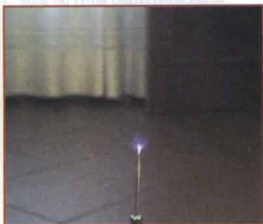
foto 1 Scarica a corona da elettrodo appuntito
