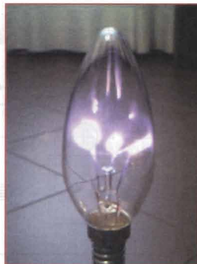
foto 3 Lampada a filamento come sfera al plasma
