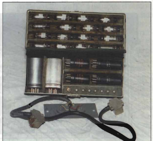
Foto 6 - Scatola ricambi e sotto, tra i due connettori, il sistema di raddrizzatori al selenio su piastrina di raffreddamento.
