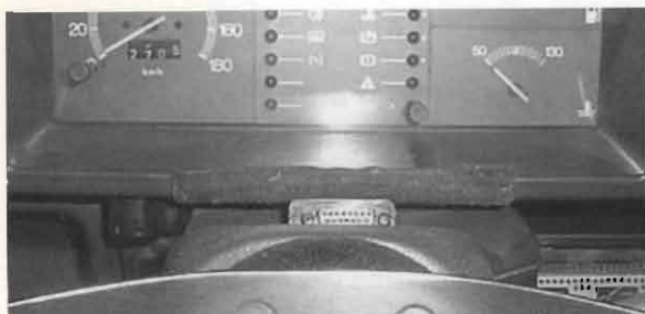
Il connettore dello Yaesu FT 4700 sulla Y10.
