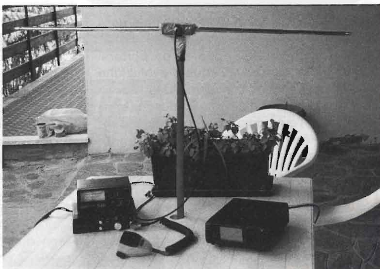
Foto 2 - La "magic antenna" pronta per le trasmissioni sui 2 mt.
