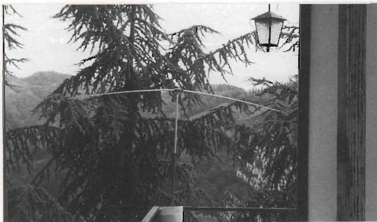
Foto 3 - "Magic antenna" pronta per le trasmissioni sui 50 MHz. Come si può vedere, essa è fissata su di un manico di scopa ed è stata collocata in una posizione nelle cui vicinanze sono presenti degli ostacoli (cioè alcuni alti alberi) per simulare le condizioni operative tipiche delle vacanze in montagna.
