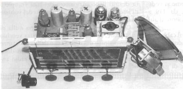
Foto 3 - Il telaio messo a nudo, con l'ampia scala parlante.
