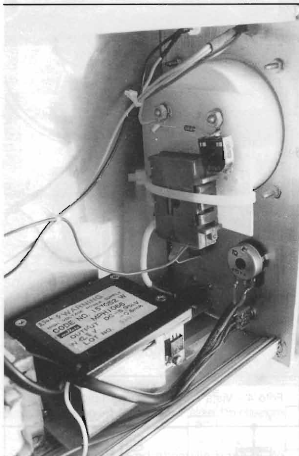
Foto 5 - Vista interna dello strumento: fissato sui morsetti del microamperometro (in alto) è visibile il ritaglio di vetronite con lo shunt per l'alta tensione, mentre sul fondo della scatola è montato il modulo convertitore DC/DC.
