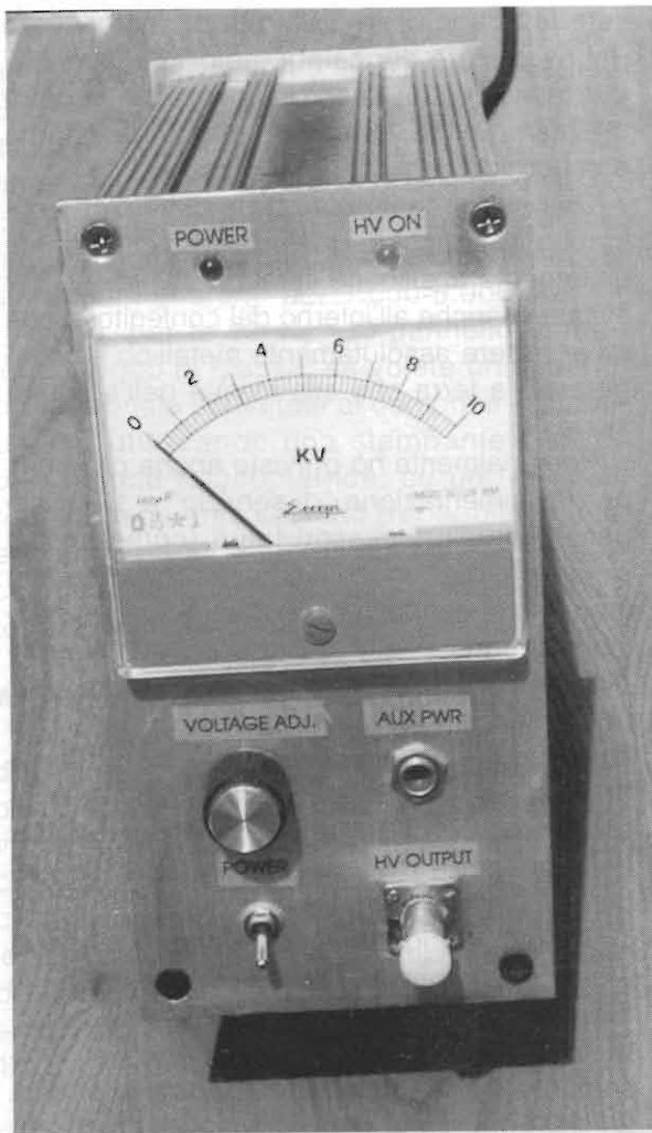
Foto 3 - Vista del pannello frontale: si notino il voltmetro ad ampia scala e le spie di sicurezza (POWER ON, HV ON).
