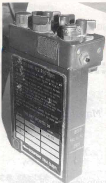
Foto 2 - Sono visibili il PTT, l'altoparlantino, il microfono e le istruzioni.
