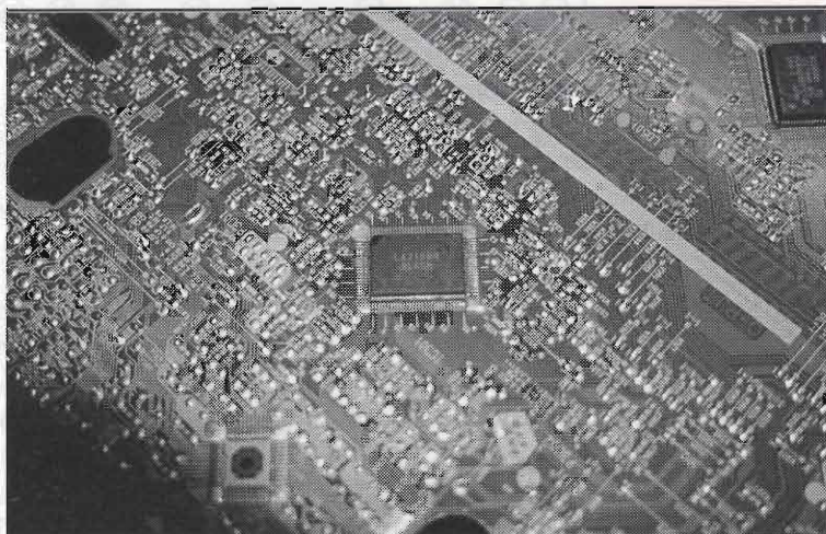
Foto 4 - Il processore video LA 71594M.
