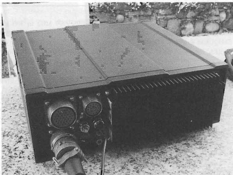
Foto 4 - Vista dal retro (bocchettoni di alimentazione, controllo remoto, bocchettone di uscita, dissipatore del finale di potenza.
