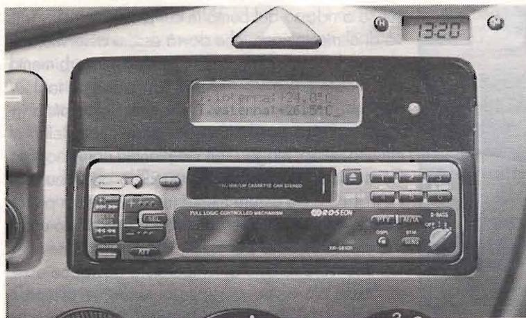
Foto 6 - Particolare del display integrato nel cruscotto, lettura temperature.
