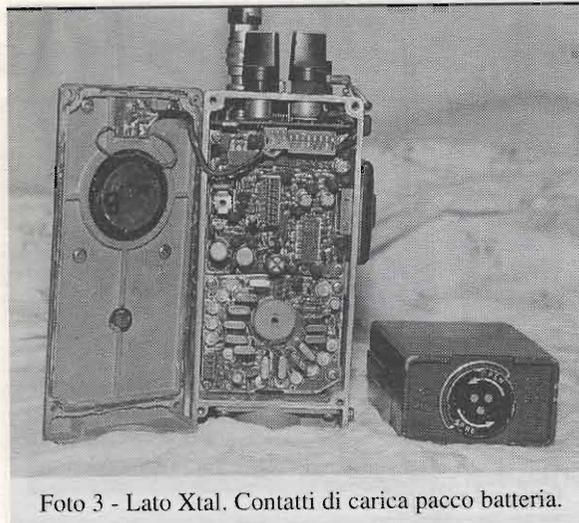
Foto 3 - Lato Xtal. Contatti di carica pacco batteria.
