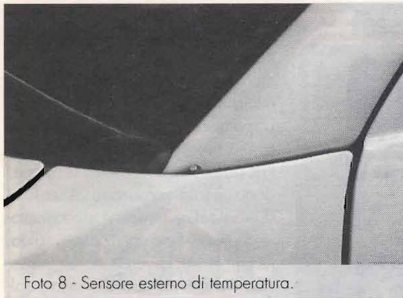
Foto 8 - Sensore esterno di temperatura.
