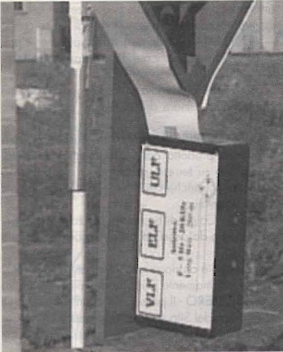
Foto 5 - Particolare della scatola delle connessioni.
