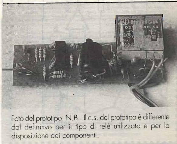
Foto del prototipo. N.B.: Il c.s. del prototipo è differente dal definitivo per il tipo di relè utilizzato e per la disposizione dei componenti.
