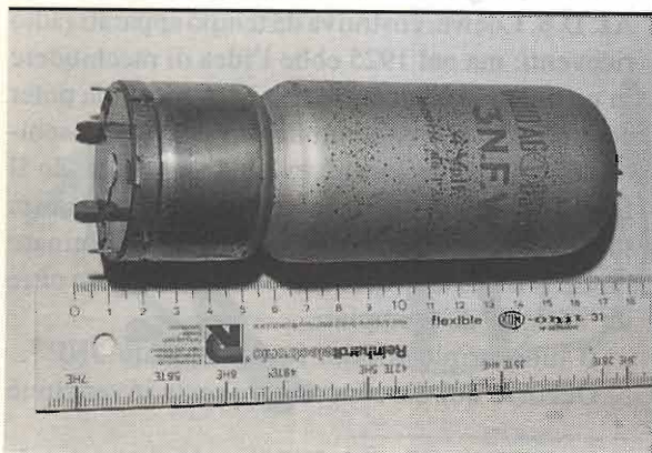
figura 3 - Il tubo 3NFW contenente tre triodi.
