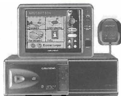
Foto 3 - Grundig utilizza un carica CDP multifunzione da mettere nel baule, dove "stipare" la cartografia.
