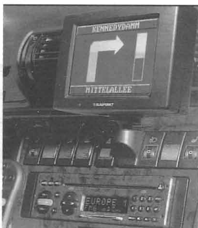
Foto 2 - Travel Pilot Blaupunkt con schermo particolarmente visibile ma a basso impatto visivo per non distrarre il pilota.
