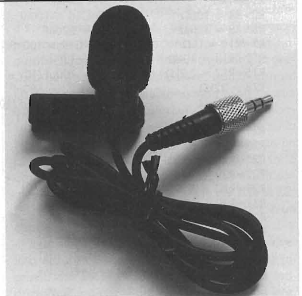
Foto 2 - Microfono amplificato a FET direttivo, ottimo per effettuare prove fonometriche.
