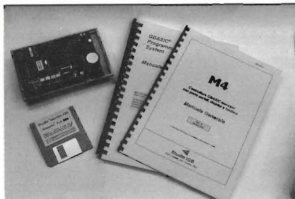
Foto 2 - la scheda M4 montata in un supporto per barra standard assieme ad un piccolo alimentatore switching. Si vedono anche i manuali GBASIC ed M4 nonché il dischetto che verrà inviato gratuitamente ai lettori di EF che lo richiederanno.
