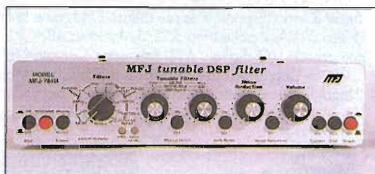
nimizzano il rumore prevenendo errori sui dati (in caso di trasmissioni digitali) e forniscono una risposta estremamente ripida fino a sfiorare i 60 dB di attenuazione ad appena 75 Hz al di fuori della frequenza di centro banda. Solamente l'MFJ 784B vi mette a disposizione 5 filtri DSP accordabili separatamente. Ognuno dei filtri può essere ottimizzato per SSB e CW migliorandone la risposta.
