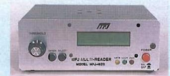
**MFJ 462** Questo nuovo MULTI READER MFJ vi permette di decodificare i segnali ricevuti in HF le modalità di ricezione selezionabili da menù operativo sono RTTY, ASCII, CW e AMTOR che servono per il traffico commerciale, militare, diplomatico, meteorologico, aeronautico, marittimo e radioamatoriale. Presa parallela per una stampante, alimentazione 12 VDC.
