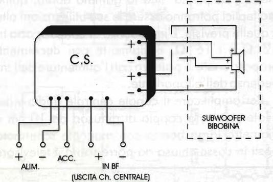
figura 5 - Cablaggio per canale subwoofer (pilotaggio subwoofer bibobina) 60 W max.
