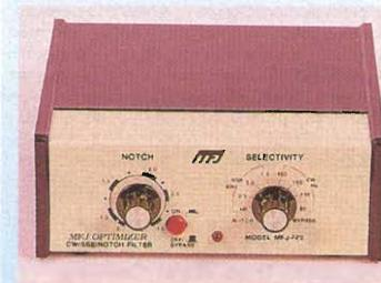
**MFJ 722.** Filtro a lama di rasoio dotato di commutatore con larghezze di banda selezionabili di 80,110,150,180 Hz centrate su 750 Hz, un filtraggio SSB al limite. Funziona da 300 a 3000 Hz selezionabili con filtro di assorbimento di 70 dB.
