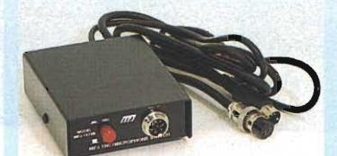
**MFJ 1272** Nuova interfaccia TNC/MIC. Collega contemporaneamente il TNC ed il microfono. Questo nuovo modello è predisposto per il collegamento con qualsiasi apparecchio per mezzo di un connettore ad 8 pin. Conveniente con l'uso di un TNC per evitare di inserire e disinserire un microfono ogni volta che si opera in packet.
