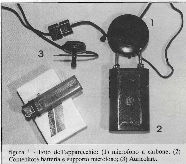
figura 1 - Foto dell'apparecchio: (1) microfono a carbone; (2) Contenitore batteria e supporto microfono; (3) Auricolare.
