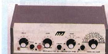
**MFJ 1040B.** Permette di ricevere segnali molto deboli. Elimina i segnali e le immagini fuori banda fino a 20 dB di guadagno da 1.8 a 54 MHz. Collega 2 antenne e due ricevitori. Bypass automatico per quando si trasmette fino a 350 Watt.
