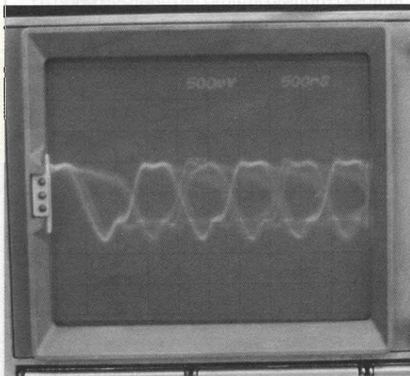
figura 10 - Segnale Manchester prelevato al connettore J3.
