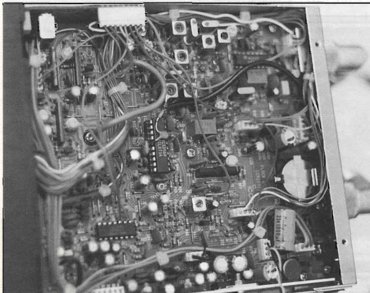
figura 6 - Interno dell'ICR-100: prelievo del segnale IF 10.7 MHz.
