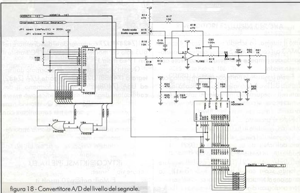
figura 18 - Convertitore A/D del livello del segnale.
