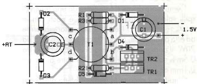
l'elenco componenti. R1, R2 e R3 limitano la corrente di base ai transistori di commutazione.
