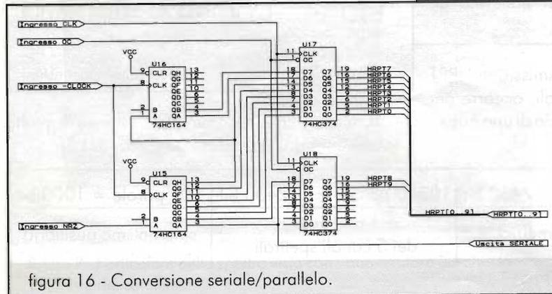
figura 16 - Conversione seriale/parallelo.
