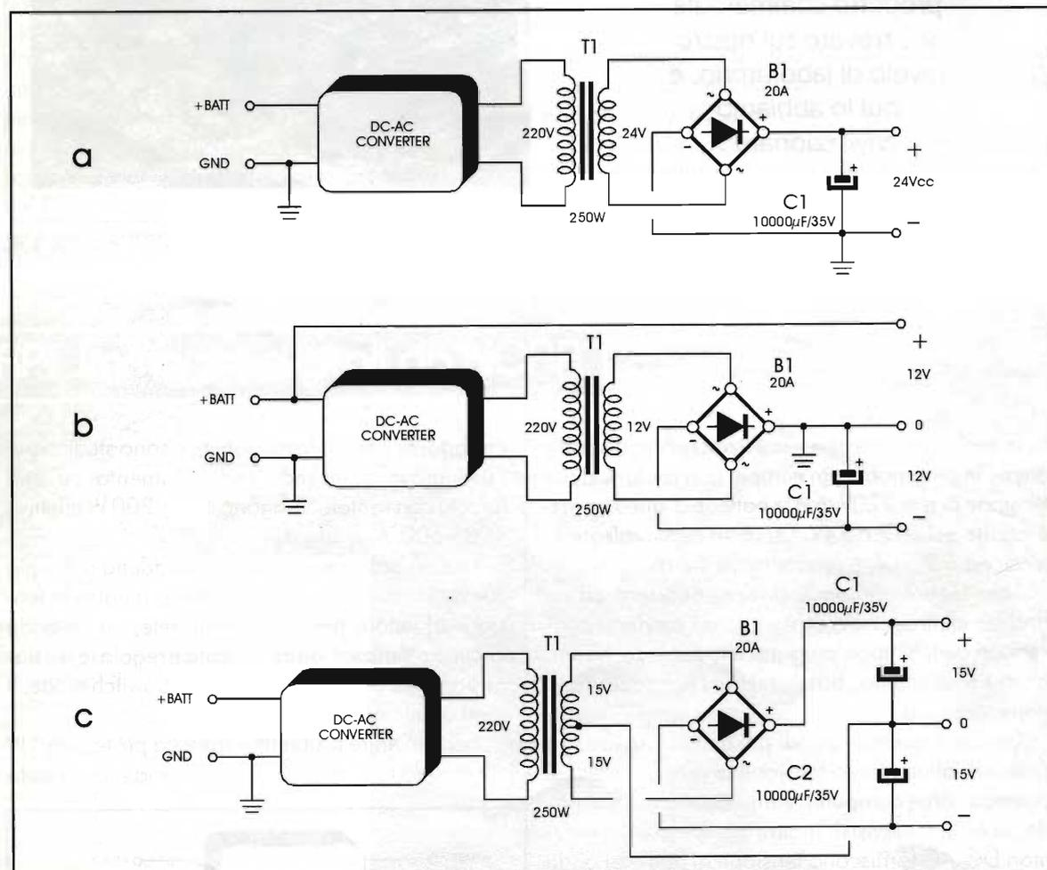
figura 2 - Utilizzo come convertitore DC/AC di tensione:
