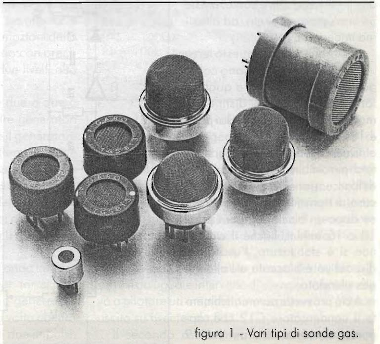
figura 1 - Vari tipi di sonde gas.
