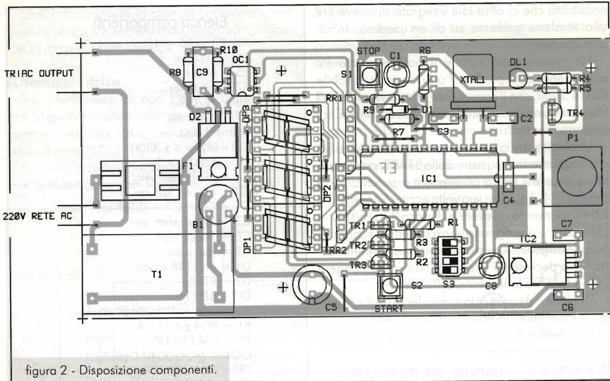
Infine il quarto SWITCH messo a massa ferma le cifre sullo 000, se impostiamo per esempio 10 secondi premendo lo START vedremo sui display 009-008-007-006-005-004-003-002-001-000 a questo punto si disecciterà il TR4 e contemporaneamente sui display riappare 010.
