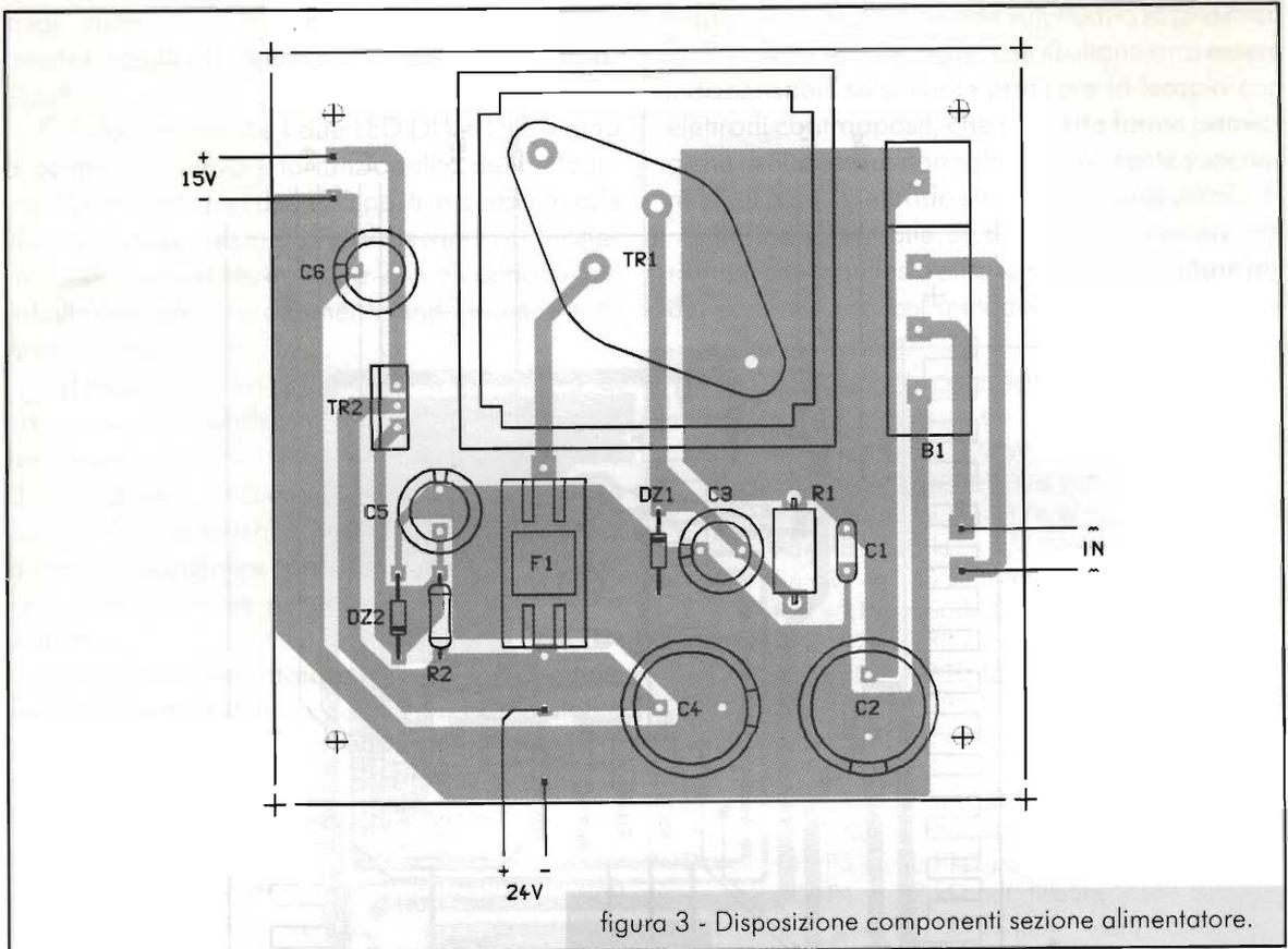
figura 3 - Disposizione componenti sezione alimentatore.
