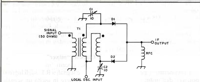
figura 1c - Mixer bilanciamento singolo.
