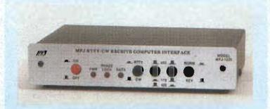
**MFJ 1225** Interfaccia per computer solo per la ricezione dei segnali RTTY, ASCII, CW. Ha tutte le caratteristiche dell'MFJ 1224 ma opera solo in ricezione. I software di gestione per l'MFJ 1224 e 1225 sono disponibili su disco sia per IBM che per i possessori di COMMODORE 64/128 e VIC-20.
