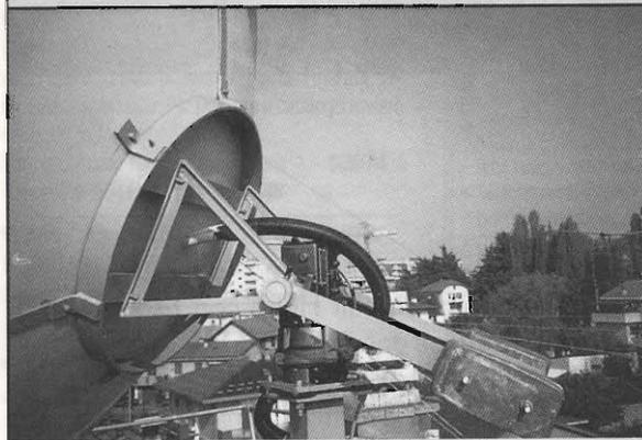
figura 3 - Parabola ancorata al rotore doppio (azimuth ed elevazione) vista laterale.
