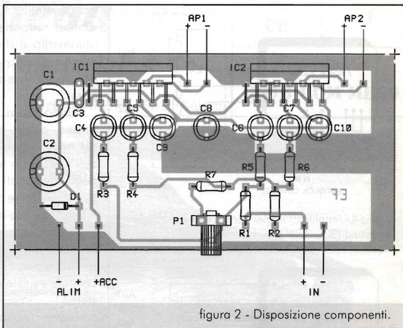
figura 2 - Disposizione componenti.
