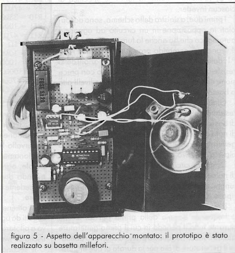
figura 5 - Aspetto dell'apparecchio montato: il prototipo è stato realizzato su basetta millefori.
