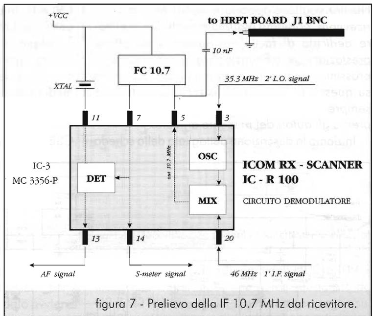
del progetto. Su alcuni ricevitori commerciali, esiste già un'uscita del segnale a 10.7 MHz. È molto importante verificare che l'ampiezza di tale segnale sia sufficiente a pilotare la scheda. Le misure effettuate con oscilloscopio indicano 20mV pp sul BNC J1 per un corretto funzionamento. Se il segnale non basta consigliamo di amplificarlo il più vicino possibile al punto di prelievo con un transistor o un integrato monolitico (es. MAR6) prima di essere inserito nel cavo.
