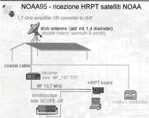
figura 1 - Sistema di ricezione HRPT NOAA95.
