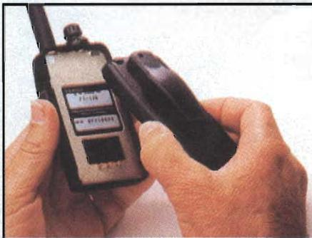
Semplice montaggio e smontaggio batteria
