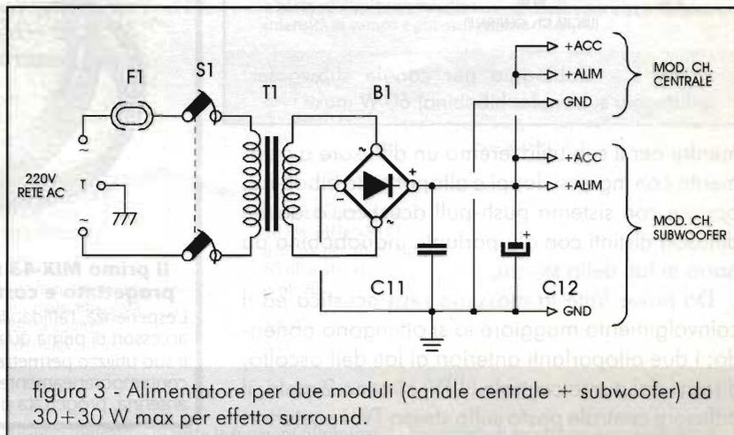
figura 3 - Alimentatore per due moduli (canale centrale + subwoofer) da 30+30 W max per effetto surround.
