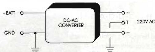
figura 1 - Montaggio classico del convertitore DC/AC.
