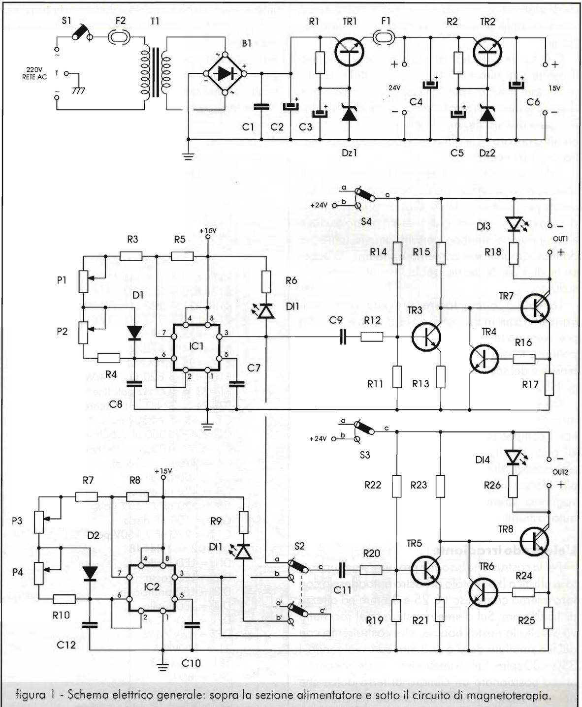
figura 1 - Schema elettrico generale: sopra la sezione alimentatore e sotto il circuito di magnetoterapia.
