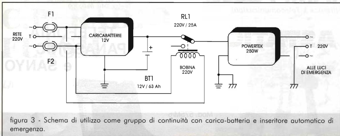
figura 3 - Schema di utilizzo come gruppo di continuità con carica-batteria e inseritore automatico di emergenza.
