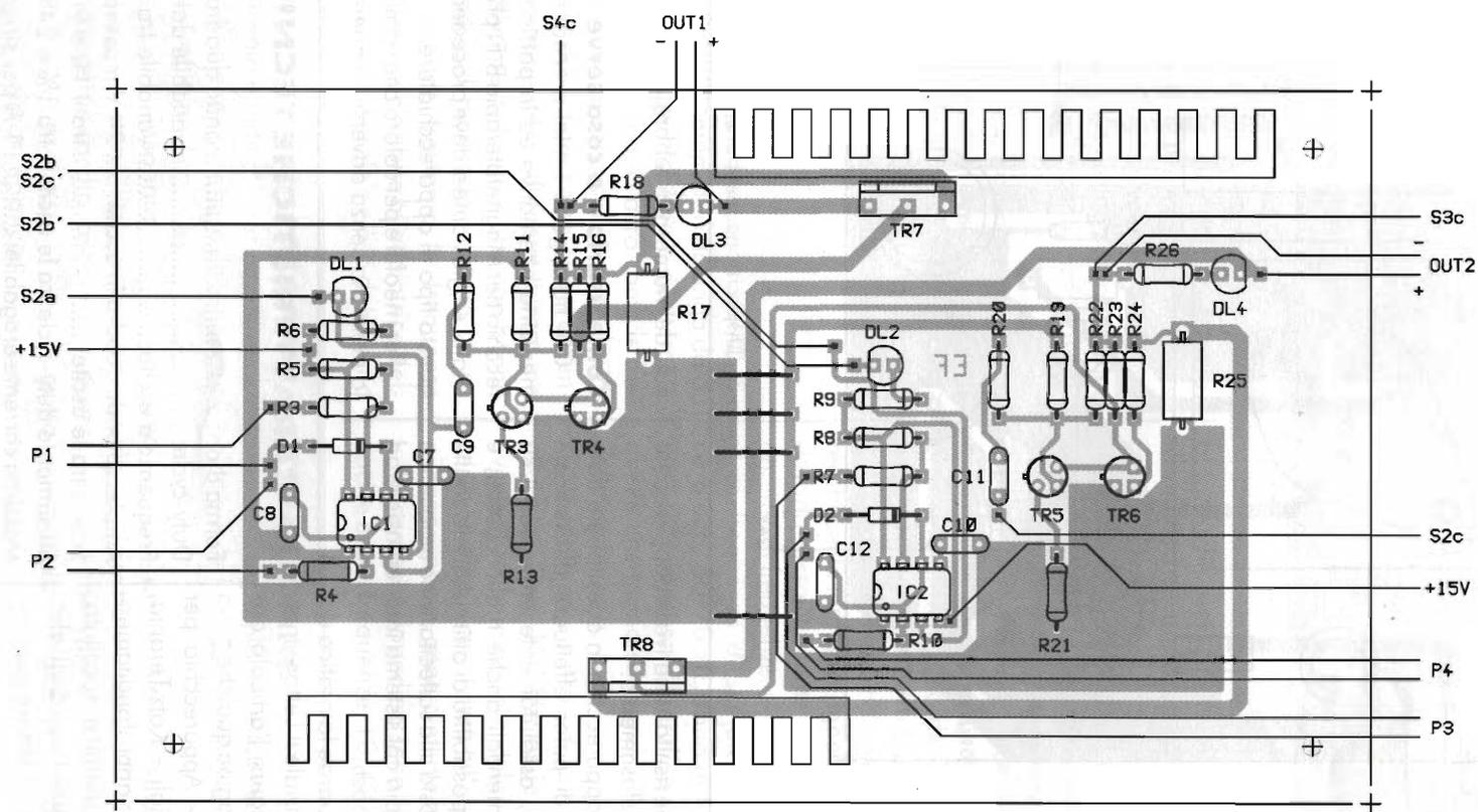
figura 2 - Disposizione componenti della sezione di circuito relativo alla magnetoterapia.
