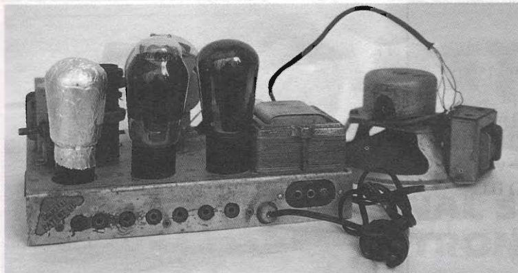
figura 3 - Il telaio visto da dietro. La prima valvola a sinistra è la rivelatrice 904 che aveva perduto quasi interamente la sua vernice conduttrice esterna, da me ripristinata provvisoriamente con un foglio di alluminio e successivamente con vernicetta conduttrice.
