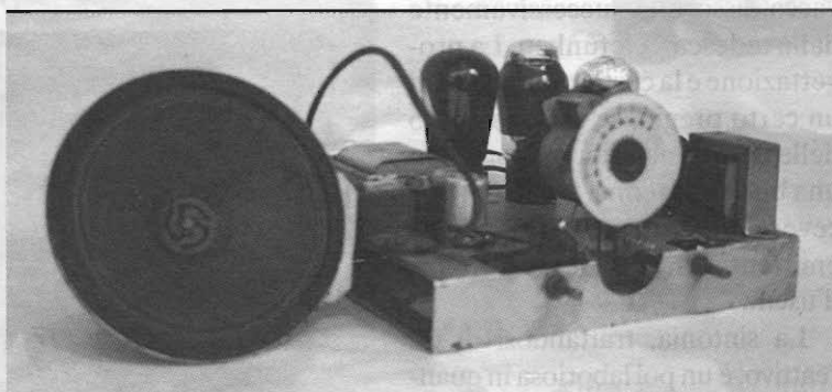
figura 2 - Telaio e altoparlante fuori dal mobile. Si notino il variabile di reazione (a sinistra), il variabile di sintonia con la scala a disco (al centro) e dietro le tre valvole in fila.
