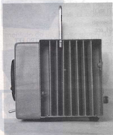
figura 4 - Disposizione della resistenza dissipatrice e del diodo rettificatore in bagno d'olio.
