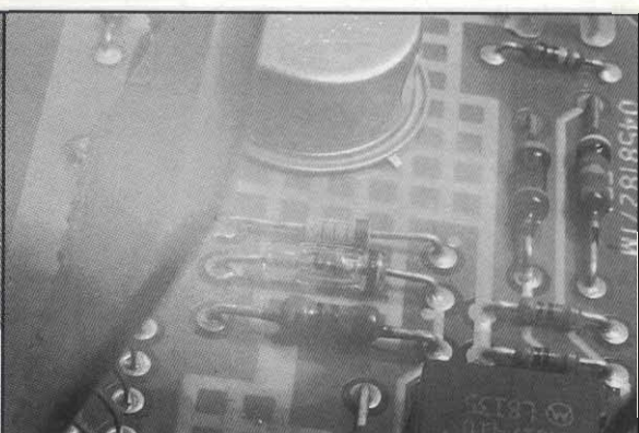
21 - Particolare del diodo zener di precisione utilizzato per generare tutte le tensioni critiche all'interno del circuito (leggi tensione di varicap e riferimenti per il circuito del termostato). Nell'assemblaggio finale, il diodo zener di riferimento si verrà a trovare all'interno della camera termostatica.
