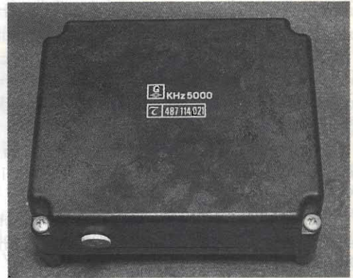
1 - Veduta dell'OCXO Telettra 487.114.021. Notare, in basso a sinistra, il tappo di gomma che copre il foro del contenitore attraverso il quale è possibile accedere al trimmer per la regolazione fine della frequenza di uscita.
