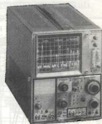
Oscilloscopio TEKTRONIX mod. 7603 con cassetto analizzatore di spettro 7L5 opt.025
