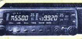
TM 733 - Veicolare bibanda - VFO programmabile - doppio ascolto - predisposto packet 9600 - frontalino asportabile - 50W
