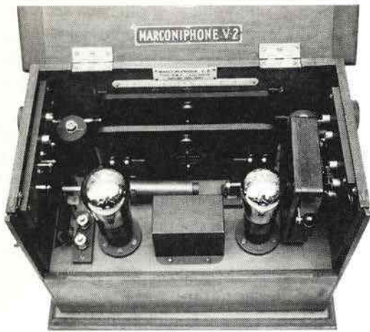
figura 11 - Veduta d'insieme dell'apparecchio con coperchio sollevato e blocchi di gamma inseriti.
