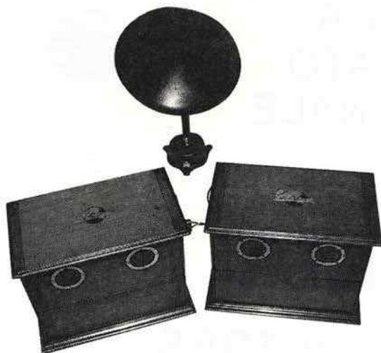
figura 14 - La serie completa dei due apparati V2 e A2 con il diffusore a collo di cigno mod. Popular 1924.
