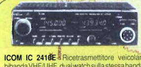
ICOM IC 2416E Ricetrasmittitore veicolare bibanda VHF/UHF, dual watch sulla stessa banda, duplexer interno, possibilità di ricerca entro le memorie o entro un limite di banda. Potenza 45 W (35 W in UHF)
