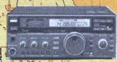
FT289 - Potenza 100W RX-TX a copertura generale
