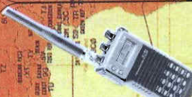
IC R11 - Ricettore di ridottissime dimensioni per frequenze da 100KHz a 1300 MHz
