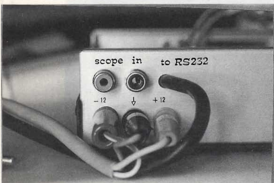
Foto 6 - Vista posteriore. Oltre agli ingressi per l'alimentazione duale si trovano due prese RCA per l'ingresso BF dal ricevitore meteo (in) e per l'uscita verso l'oscilloscopio per monitorare l'involuppo di corrente che entra nel convertitore con la porta seriale del PC.
