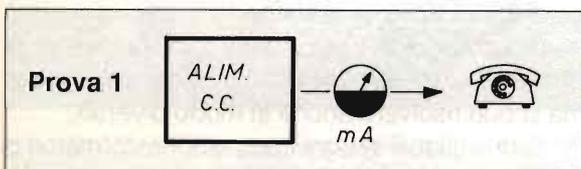
Con una tensione continua di 6/7 volt si verifica se il telefono impegna e disimpegna correttamente la linea (10 - 30 mA a cornetta alzata, nessun assorbimento a cornetta abbassata) ed inoltre, parlando nel microfono, potremo ascoltarci nell'auricolare; pur essendo un controllo un po' sommario spesso è già indicativo.
