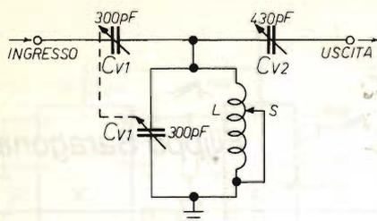
figura 1 - Schema elettrico
