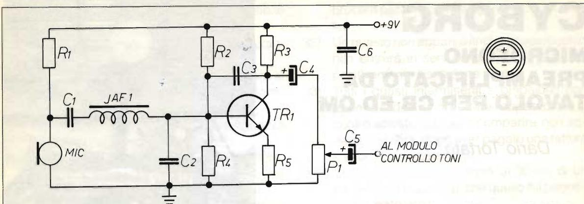
figura 2 - Preamplificatore microfonico.
