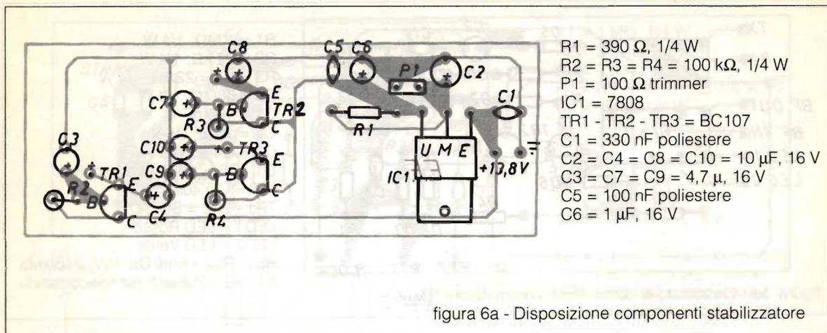
figura 6a - Disposizione componenti stabilizzatore
