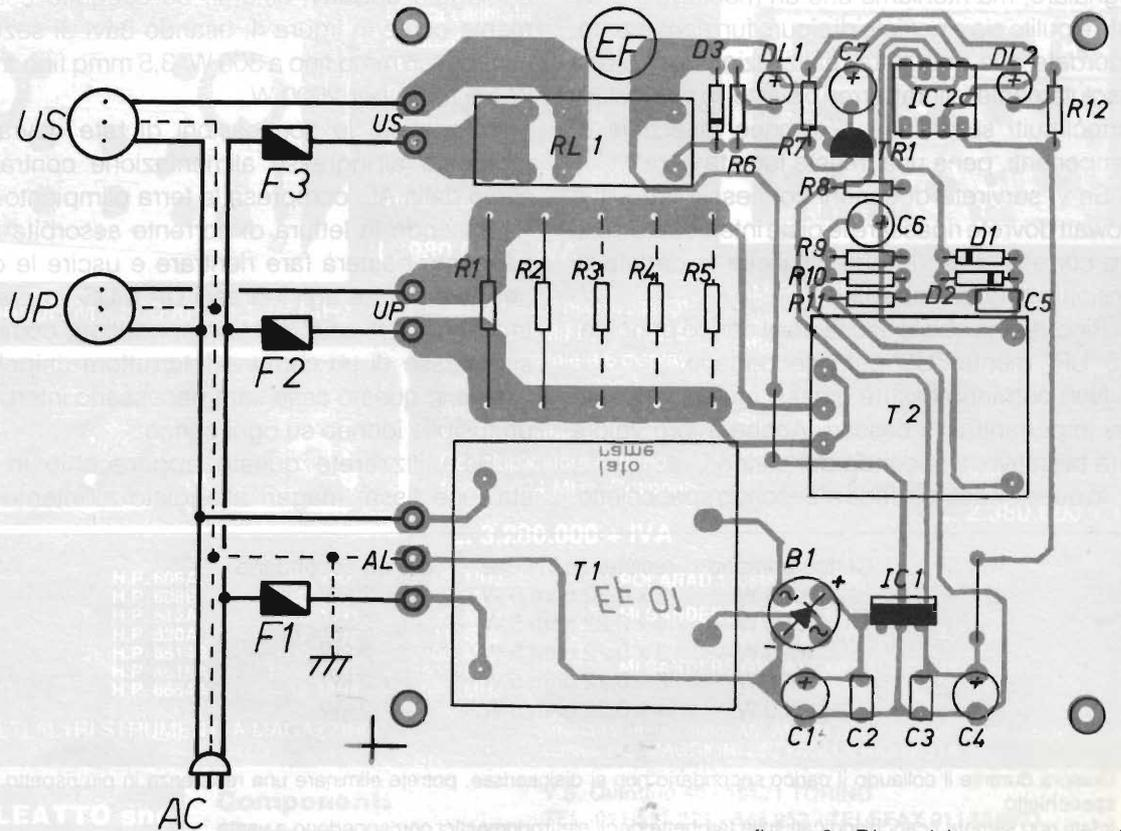
figura 3 - Disposizione componenti.
