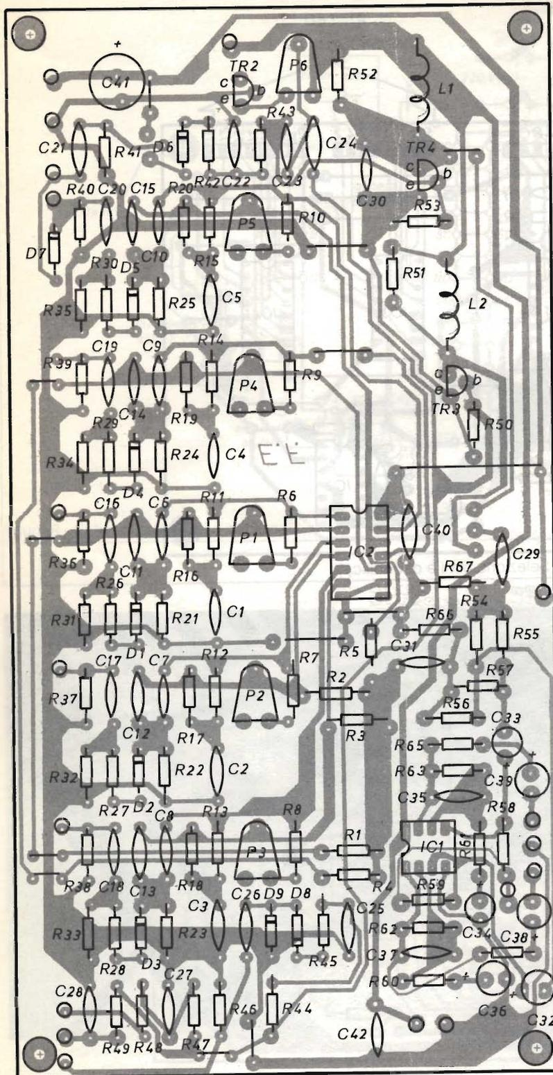
figura 9 - Disposizione componenti "Generatore di timbriche".
