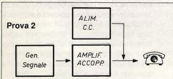
Verifica del funzionamento della parte "ricevente" dalla spina all'auricolare telefonico (ovviamente per un funzionamento corretto il segnale del generatore dovrà essere chiaramente udibile nella cornetta).
