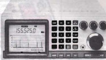
Scanner con analizzatore CRT incorporato.
