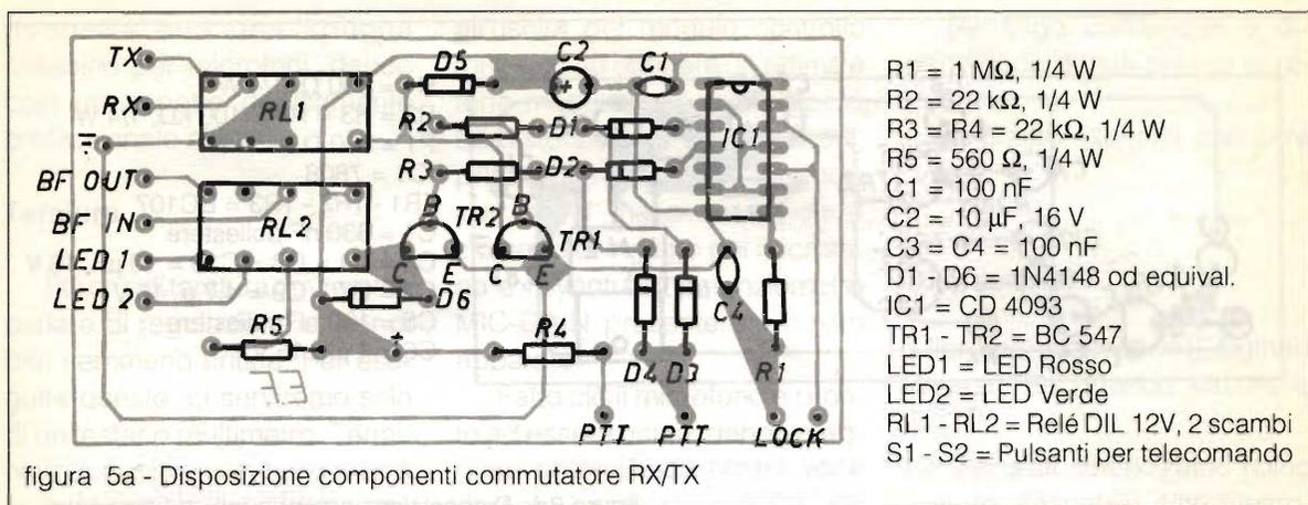
figura 5a - Disposizione componenti commutatore RX/TX
