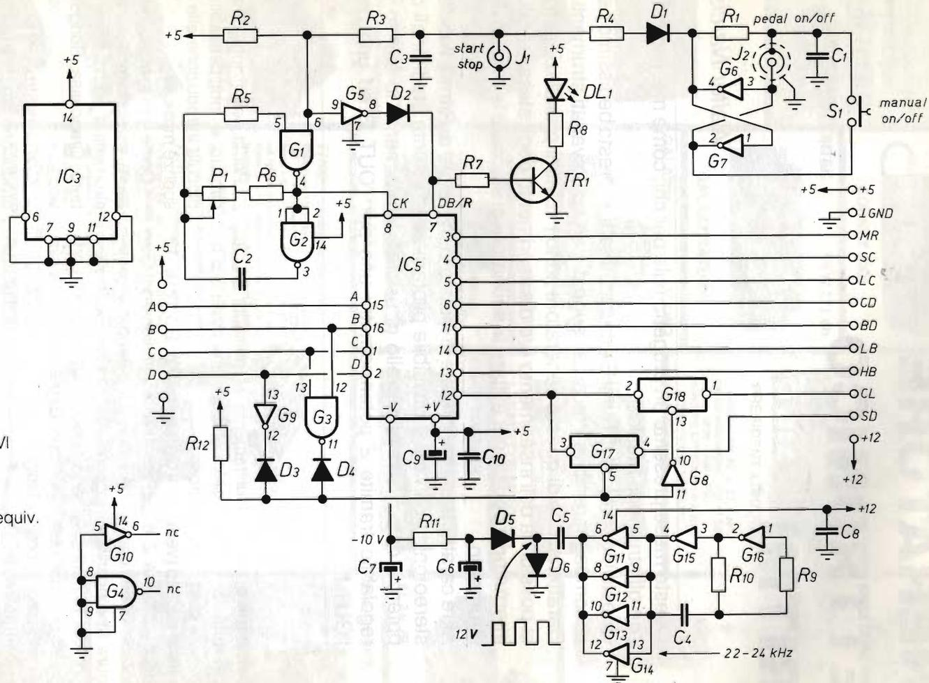
figura 1 - Schema elettrico "Generatore di sequenze".
