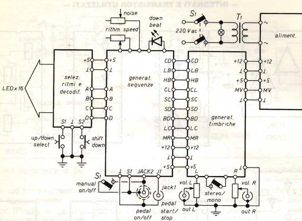
figura 6 - Schema a blocchi e cablaggi.
