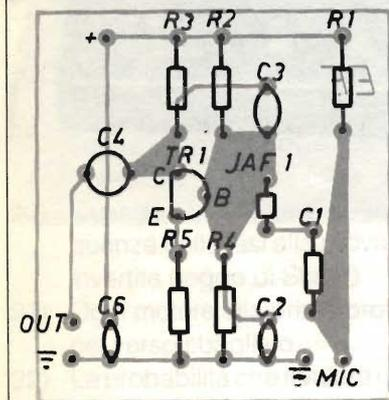
figura 2a - Disposizione componenti.
