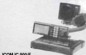
ICOM IC 900/E Il veicolare FM multibanda composto da una unità di controllo alla quale si possono collegare sino a sei moduli per frequenze da 28 MHz a 1200 MHz due bande selezionabili indicate contemporaneamente sui display. Collegamenti a fibre ottiche.
