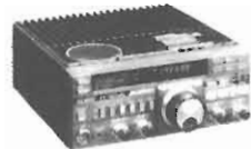
YAESU FT 757 GX II Ricevitore HF, FM, AM, SSB, CW, trasmissione a ricezione continua da 1,6 a 30 MHz, ricezione 0,1-30 MHz, potenza RF-200 W PeP in SSB, CW, scheda FM optional.
