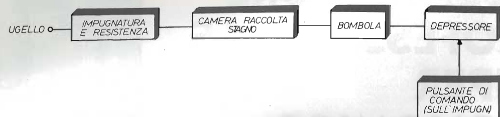
figura 1 - Schema a blocchi di tipico dissaldatore.
