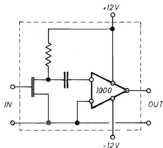
figura 1- Schema semplificato dell'amplificatore. Lo stadio d'ingresso, costituito da un FET ad alta transconduttanza, guadagna 50. Gli stadi successivi guadagnano 1000. Tutto il circuito è montato all'interno di una scatola metallica.
