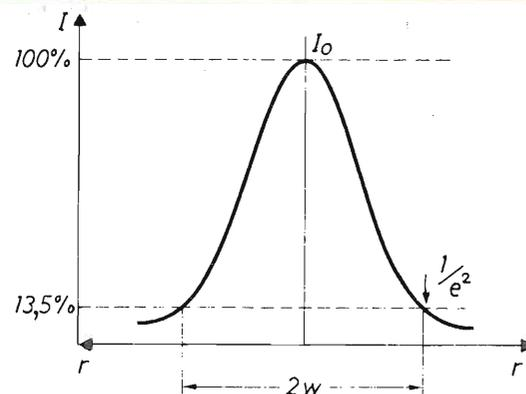
figura 5 - Curva per un modo 00  $1/e^2$  dell'intensità corrisponde a 13,5% del massimo dell'irradianza  $I_0$ .
