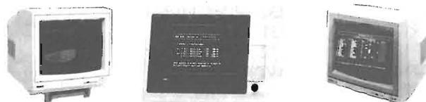
**MD7 TVM** - Monitor a colori da 14" per scheda EGA ad alta risoluzione (640 x 350). Doppia frequenza di scansione: 15,75 KHz e 21,85 KHz/0,31 dot pitch. Schermo antiriflesso tubo a 90°. Alimentazione a 220 V 85W. Ingresso a 9 pin. Vedi foto P 14 T. **L. 1.100.000**
