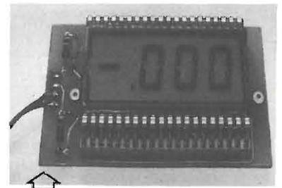
**MK 595 VOLTMETRO DIGITALE 31/2 LCD** da 200 mV a 200 V con autozero, indicazione del fuoriscala e di tensione negativa in ingresso. Dimensioni 70 x 40 mm.
