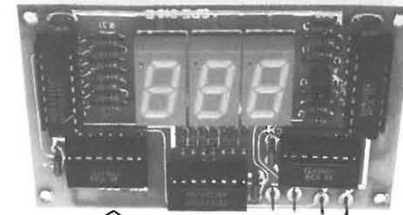
**MK 725 CONTATORE DIGITALE 31/2 CIFRE** Contatore digitale in grado di visualizzare conteggi da 0 a 1999. Può essere alimentato con tensioni comprese fra 5 e 12V cc. Ingressi di conteggio e reset. Ideale per contapezzi, contatore d'eventi, contasecondi/minuti/ore ecc. Il kit è corredato di schemi per l'utilizzo con i più svariati sistemi di conteggio: ottico, contatto, magnetico (effetto hall). Finecorsa ecc.
