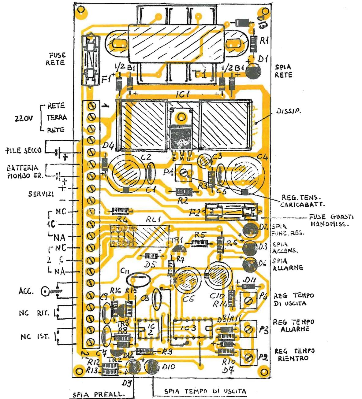
figura 2 - Piano componenti e cablaggi centralina.
