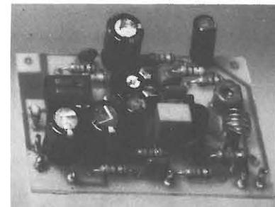
**MK 680 MICRORICEVITORE AM 150 MHz PER MK 590** Microricevitore dalle dimensioni estremamente ridotte con ottime caratteristiche (sens > 1,5 uV per 12 dB sinad) espressamente studiato per essere usato in coppia con l'MK 590 kit completo di contenitore ed auricolare. Tale ricevitore spazia tutta la banda compresa fra 100 e 180 MHz per cui è possibile l'ascolto delle conversazioni aeronautiche, pontiradio, ecc.
