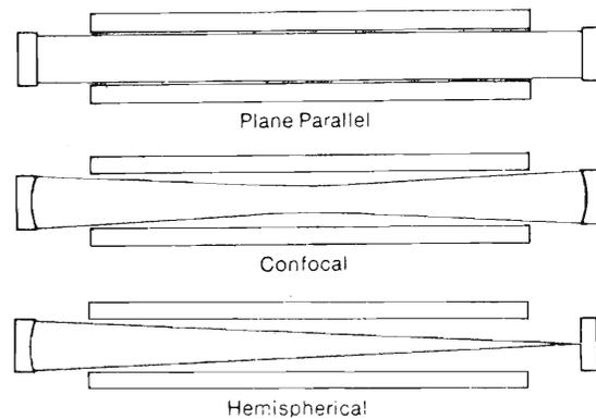
figura 2 - Alcuni tipi di cavità risonanti.
