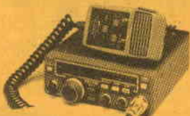
ICOM IC 25 E-H (IC25H 45 W) Ricetrasmittitore veicolare 144/146 MHz, potes- ta uscita RF 1 + 25 W, (variabile) alimentazione 13,8 Vdc, microfono con scanner e blocco fre- quenze fornito, passi di 5 kHz/25 kHz, funziona- mento automatico.
