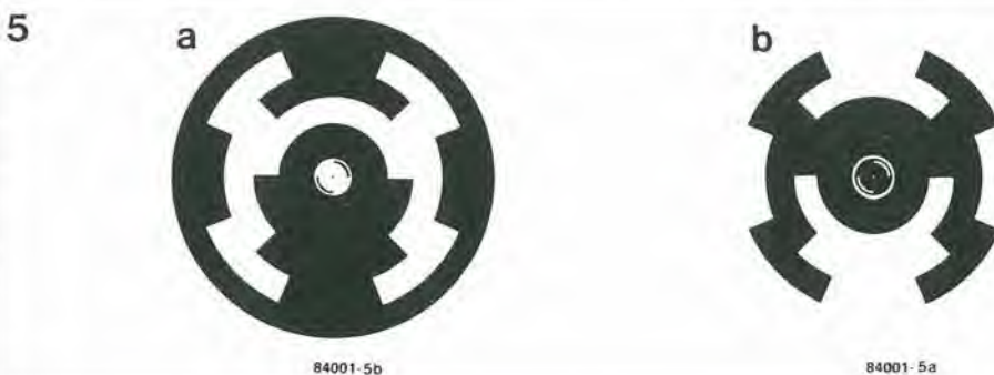
Figura 5. Profilo del disco di codifica (qui rappresentato in scala 1:2). Probabilmente, il modo più facile di costruire questo disco è di ricavarlo da una lastra per circuiti stampati mediante un seghetto da traforo. La Figura 5a è la dima da usare quando vengano usati i sensori a riflessione, mentre il disco di Figura 5b serve per i sensori a trasmissione, con i LED al di sopra del disco ed i fototransistori al di sotto. I dischi sono anche disegnati in grandezza naturale nella rubrica Service.
