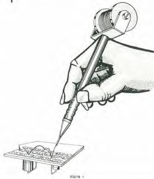
Figura 1. Il puntale per cablaggio completamente montato. E' possibile vedere chiaramente come viene eseguito il cablaggio con questo attrezzo.
