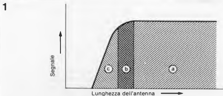
Figura 1. Rapporto segnale / rumore in funzione di una lunghezza assoluta 1 dell'antenna, a frequenza costante.
