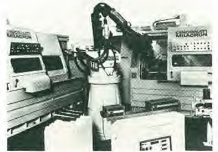
Una Cincinnati T1, che serve due centri di fornitura ed una stazione di collaudo.
