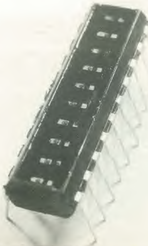
Foto 4. Un gruppo di 10 LED inseriti in un contenitore dual-in-line.
