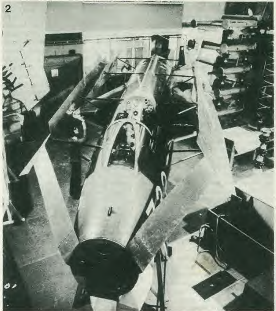
Foto 2. Fusoliera d'aereo montata in un sistema di conduttori quasi coassiale per la prova degli effetti indiretti. Si possono inserire pannelli di materiali diversi e di diverse dimensioni.
