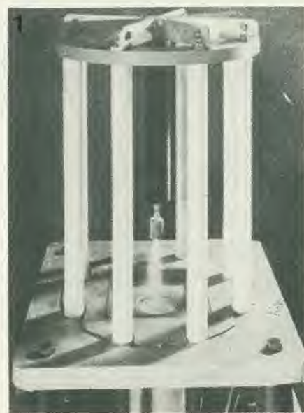
Foto 1. Equipaggiamento di prova ad arco con alimentazione simmetrica della corrente.
