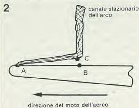
Figura 2. Dopo l'impatto originario in A, il canale di scarica si trasferisce in B quando il potenziale elettrico su C-B è grande a sufficienza da scaricarsi attraverso questa distanza.
