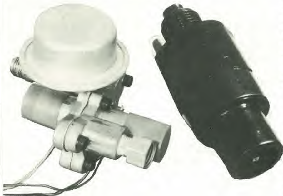
Figura 1. I due trasduttori principali che servono per il misuratore del consumo. Il trasduttore della velocità va montato nel cavo di controllo del tachimetro; il sensore di flusso va inserito nel tubo posto tra la pompa ed il carburatore.
