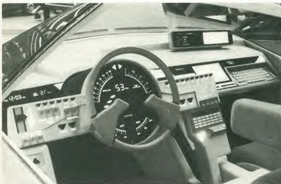
Foto 4a. Risultati di uno studio della Ford relativo all'impiego estensivo dell'elettronica nei veicoli a motore.
