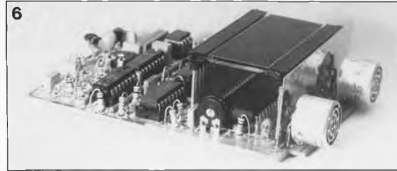
Figure 6. Il faut mettre l'affichage LCD sur des "échasses" de manière à le positionner parfaitement en regard de la fenêtre du boîtier. Remarquez en passant la technique adoptée pour le blindage.
