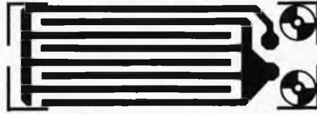
Détecteur de fluide: circuit principal
