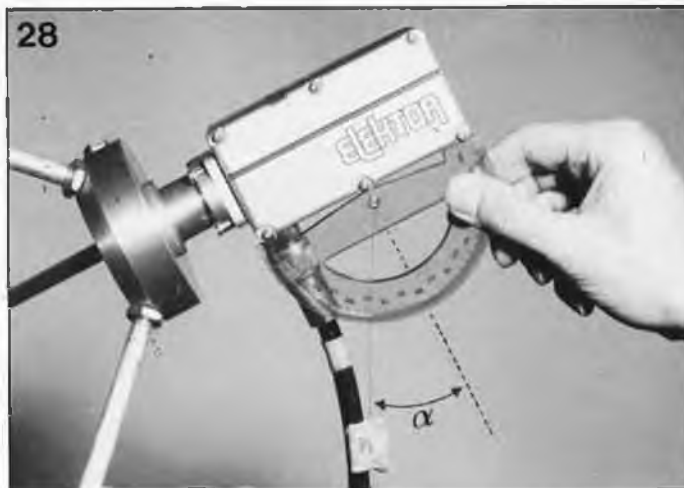
Figure 28. Un rapporteur d'écolier et un fil à plomb de fortune suffisent pour la recherche de l'angle d'élévation (la position sur la photographie n'est qu'un exemple).
