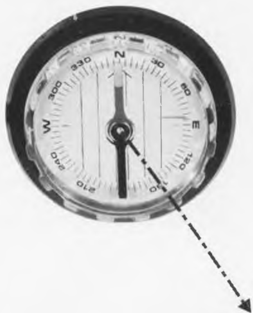
Figure 27. Utilisation d'un compas pour repérer approximativement l'azimut d'une parabole (la position sur la photographie n'est qu'un exemple).
