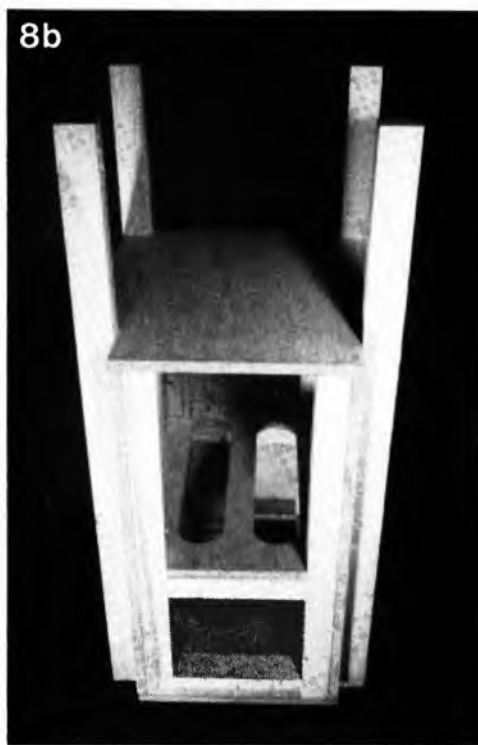
Figure 8. Mise en scène des différentes étapes de la réalisation de l'enceinte. En 8a les différents éléments sciés; en 8b, le caisson de grave presque terminé; en 8c première phase de la construction du caisson de médium/aigu, en 8d la seconde phase du même processus.
