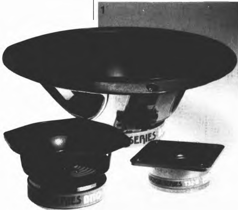
Figure 1. Les trois châssis montés dans la PL 301: un woofer de 30 cm, un HP de médium de 13 cm et un tweeter à dôme de 52 mm.
