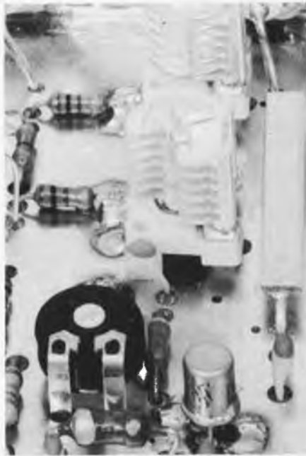
Photo 3. Vue détaillée du convertisseur de réception. La ligne accordée du filtre d'entrée est la seule dans tout de montage à être montée flottante au dessus du circuit imprimé. Les ajustables visibles sur la photo sont destinés à faciliter les réglages.
