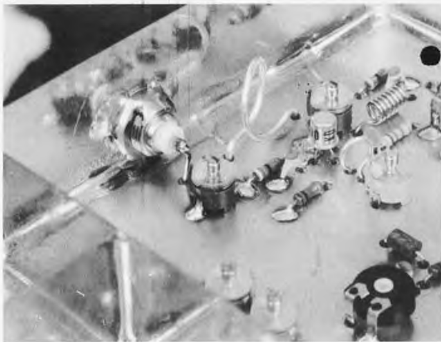
Photo 5. Coup d'oeil sur l'étage final. Liberté est laissée au constructeur en ce qui concerne le choix du type de transistors: sur la photo c'est un BFY 90 qui est utilisé.
