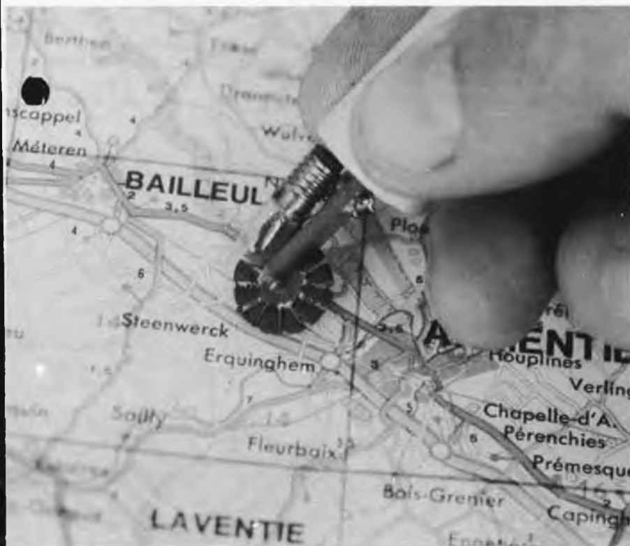
Photo 1. Exemple de capteur amateur, construit à l'aide de pièces extraites d'une vieille montre.
