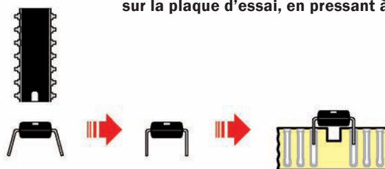
Fig 8 : Pour préparer la mise en place du circuit CD 4069 nommé IC1, vous devez le positionner à cheval sur la bande centrale comme indiqué sur la figure ci-contre, le repère en U étant vers la gauche. Faites attention de bien positionner le repère vers la gauche, sinon le circuit ne fonctionnera pas. Avant d'insérer le circuit intégré nous vous conseillons de plier légèrement les deux rangées de broches avec une petite pince, en les mettant parfaitement parallèles, comme indiqué sur la figure. Une fois ceci effectué, insérer dans la position indiquée le circuit sur la plaque d'essai, en pressant à fond sur le boîtier.
