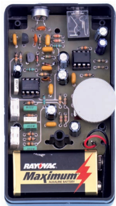
Figure 7 : Photo d'un des prototypes de la platine du microphone installée dans son boîtier plastique. Il est disponible déjà percé avec l'ensemble du matériel nécessaire. Voyez en bas le logement pour la pile de 9 V alimentant le montage.
