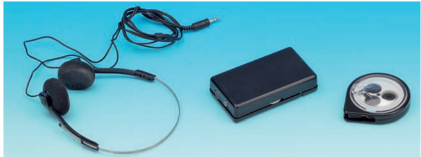
Figure 1 : Photo montrant le microphone préamplifié dans son boîtier plastique et le casque d'écoute.
