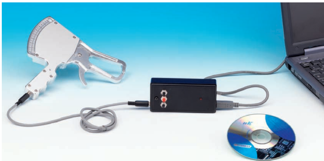
Figure 1 : Photo d'un des prototypes du plicomètre où l'on voit la carte USB EN1734K, la pince plicométrique et le CDRom contenant le programme «Plicomètre». Avec tout ce matériel/logiciel vous pourrez mesurer la masse grasse du corps humain en suivant les indications données dans cet article.
