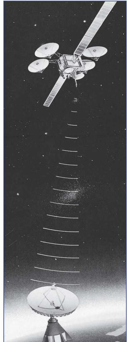
Figure 4 : Sur chaque satellite se trouvent des récepteurs qui captent les programmes de télévision que les différentes stations émettrices terrestres lui envoient.
