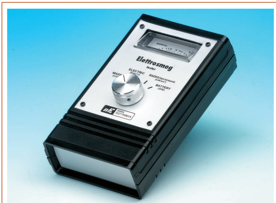
Figure 1 : Photo du détecteur de brouillard électromagnétique permettant d'effectuer les mesures de trois champs potentiellement dangereux : les champs électriques BF (basse fréquence), les champs magnétiques BF et les champs électromagnétiques RF (radiofréquence).
