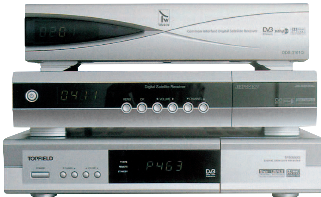
Figure 8 : Pour pouvoir recevoir un signal numérique il faut un décodeur que l'on branchera au téléviseur avec un cordon Péritel (Scart en Anglais, voir figure 3). Quand vous achetez un décodeur on vous donne une carte : insérée dans la fente elle vous permet de visionner gratuitement, pendant une courte période, les divers programmes cryptés. Si ensuite vous ne renouvelez pas l'abonnement, vous ne pourrez visionner que les programmes en clair. À la première mise sous tension du décodeur, vous devez le programmer en suivant les instructions figurant sur le manuel. Pendant cette phase le décodeur commence automatiquement à explorer toute la gamme TV et, quand il rencontre un signal, il mémorise sa FRÉQUENCE, le type de polarisation du signal, si elle est V (verticale) ou H (horizontale), puis la valeur S/R ainsi que la valeur FEC choisie par la station émettrice. Cette opération prend environ 30-40 minutes.
