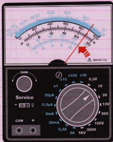
Figure 10 : Pour connaître la fréquence F1-F2 à -3 dB vous devez presser les touches + et - du générateur DDS jusqu'à porter l'aiguille du multimètre sur la position 90, correspondant à 9 V.
