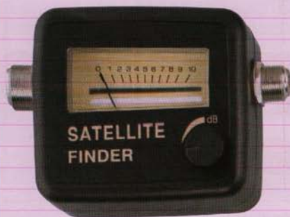
Figure 1 : Photo du Satellite Finder vu par sa face avant. Au connecteur F de droite on relie le connecteur mâle du câble coaxial provenant de l'étage d'alimentation et à celui de gauche le connecteur mâle du câble coaxial à relier au convertisseur LNB (voir figure 3).
