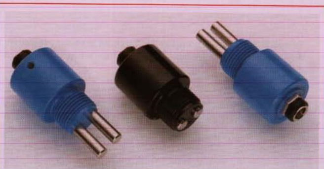
Figure 1 : La photo montre les modèles de sondes conductimétriques K5 et K1 pour le conductimètre visible en haut. La K5, photographiée sous deux angles, est de couleur bleue et on l'utilise pour les eaux oligominérales ou peu minéralisées, tandis que la K1, de couleur noire et dotée d'électrodes très courtes, est utilisée pour des mesures d'eaux très salées, plus de 1 000 microsiemens/cm.
