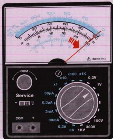
Figure 9 : Quand vous avez obtenu la fréquence d'accord exacte, mettez le multimètre sur le calibre 1 VCC et tournez le potentiomètre R5 (voir figure 1) de manière à porter l'aiguille sur le fond d'échelle marqué 100.
