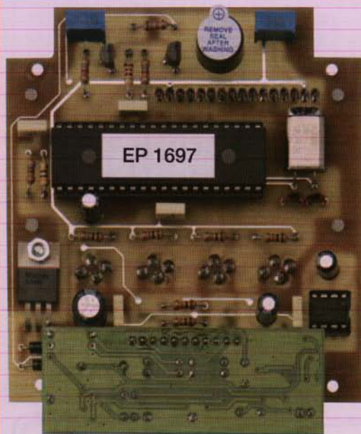
Figure 9 : Photo d'un des prototypes de la platine du conductimètre, côté composants. En bas on voit le module conductivité inséré dans son connecteur. Par commodité ne l'insérez qu'au moment de l'installation dans le boîtier, après avoir fixé la platine principale au fond du boîtier.
