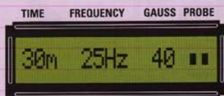
Figure 6 : Le symbole du rectangle indique que le diffuseur rectangulaire a été choisi. Avec ces diffuseurs vous pouvez choisir parmi trois valeurs de puissance : 20, 30 ou 40 gauss.
