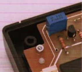
Figure 17 : Voici à quoi ressemblera l'appareil quand vous aurez fixé la platine principale au fond du boîtier. Ici le module conductivité a été mis en place.
