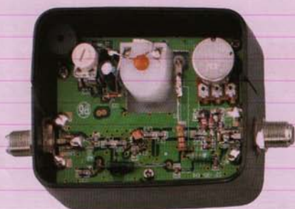
Figure 2 : Photo du Satellite Finder ouvert, une fois le fond du boîtier déposé. A l'intérieur on a un amplificateur qui amplifie tous les signaux TV d'environ 11 dB. Sur le couvercle de l'amplificateur on a les inscriptions TO REC près de la F de droite et TO LNB près de la F de gauche, celle qui va au LNB située au foyer de la parabole (voir figure 3).
