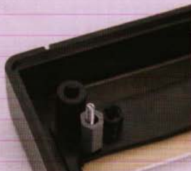
Figure 15 : Détail du montage de l'entretoise plastique sur la vis.
