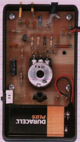
Figure 3 : Photo d'un des prototypes de la platine du Q-mètre installé dans son boîtier plastique, lequel doit être préalablement percé. Brochages de la LED vue de face et du FET vu de dessous.
