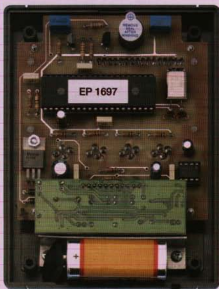
Figure 17 : Voici à quoi ressemblera l'appareil quand vous aurez fixé la platine principale au fond du boîtier. Ici le module conductivité a été mis en place.
