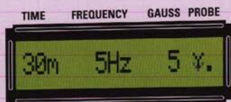
Figure 5 : L'Y majuscule et le v minuscule alternent quand le diffuseur, durant le fonctionnement de la magnétothérapie, émet un champ magnétique régulier.
