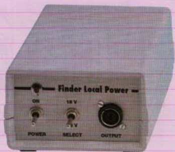
Figure 11 : Photo d'un des prototypes de l'alimentation EN1708 pour chercheur de satellites dans son boîtier plastique avec face avant et panneau arrière en aluminium anodisé. On voit en face avant les commandes Power (M/A) - Select (13/18 V) - voyant LED - OUTPUT (connecteur)
