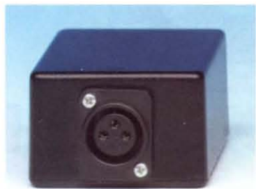
Fig.15 Photo de la petite boîte plastique noire vue du côté de la fiche femelle de type XLR à entrée symétrique. Ce boîtier est fourni déjà percé.
