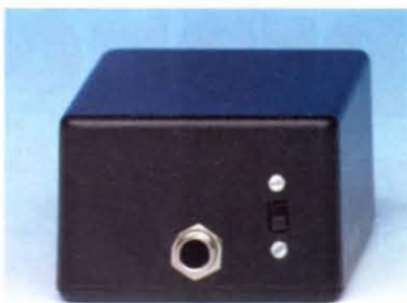
Fig.16 Sur le côté opposé à celui de la prise XLR vous devez placer l'interrupteur marche/arrêt et la prise de sortie jack stéréo pour la liaison à l'amplificateur.
